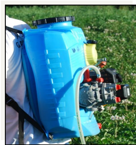
Figura 2.2 - Equipamento de pulverização de jacto projectado, utilizado nos tratamentos das diferentes modalidades.
