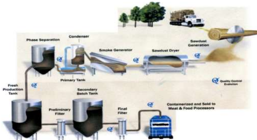
Figura 3 - Fluxograma de produção de fumo líquido (Lingbeck et al., 2014)
