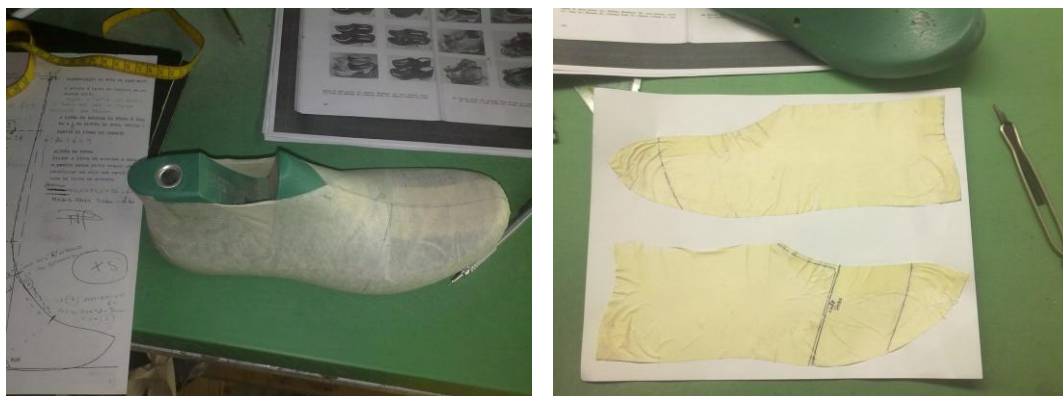
Figura 22: Da esquerda para a direita: Primeiro passo para a modelação de uma forma; colagem da fita na forma, fita com linha de dedos e altura do calcanhar.
