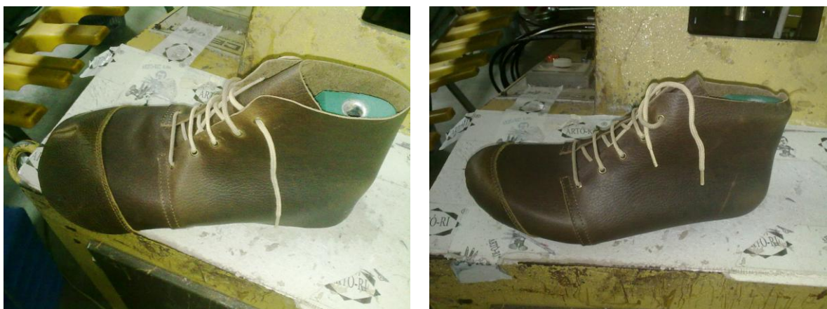
Figura 24: Da esquerda para a direita: corte do modelo assentado na forma; Modelo moldado à forma.
