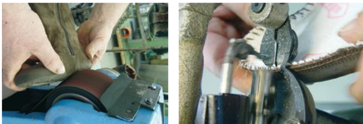
Figura 13: Da esquerda para a direita: Montagem do Sapato em AGO; montagem do Sapato em Strobel
