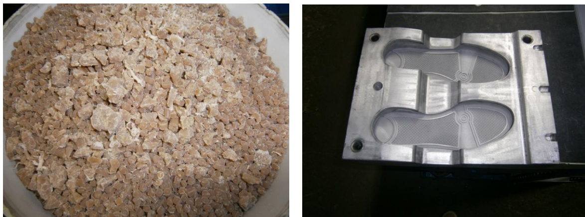
Figura 12: Da esquerda para a direita: Tr no estado Sólido, chamado de Grão; molde negativo para a injeção do Tr em estado Líquido, na empresa Euroflex.
