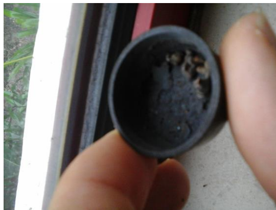
Figura 4.22 – Resíduo do pellet após a combustão no calorímetro de bomba adiabática.
