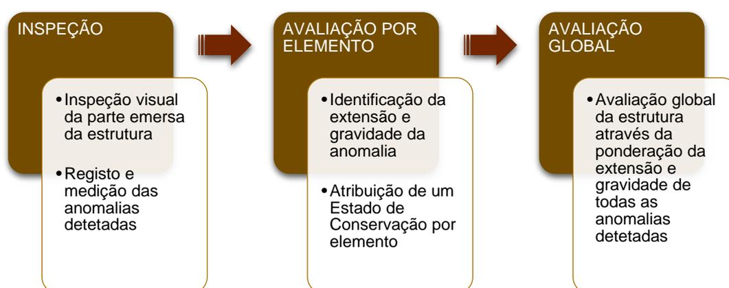
Figura 4.7 - Metodologia adotada para a inspeção de pontes em arco de alvenaria.
