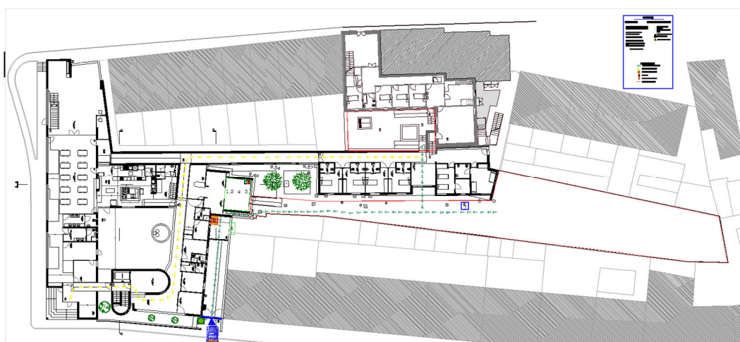
Figura 33 - Planta de estaleiro (Fonte: Projeto de Arquitetura)
