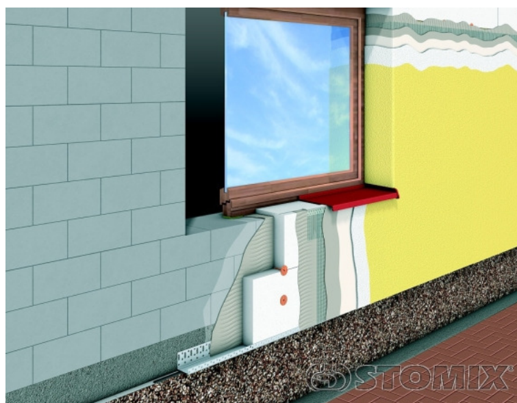
Figura 48 - Execução de ETICS (Fonte: http://www.engenhariaeconstrucao.com )
