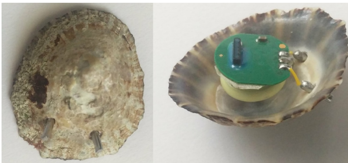
Figura 4 Logger alterado para o formato Lapa
