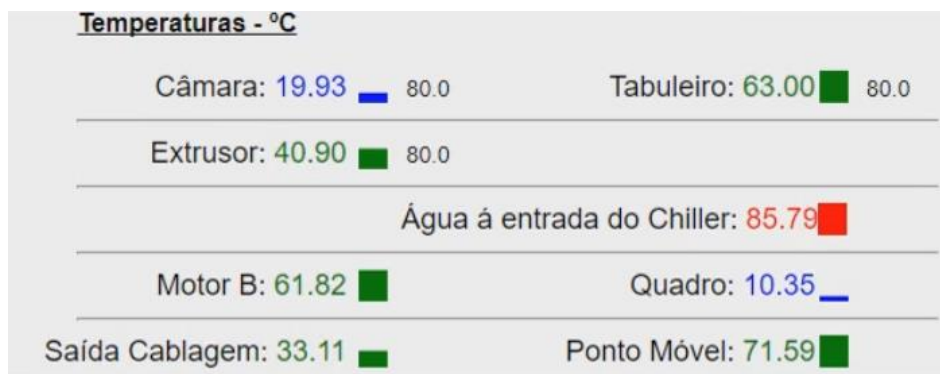
Figura 57 - Visualização das temperaturas na HMI
