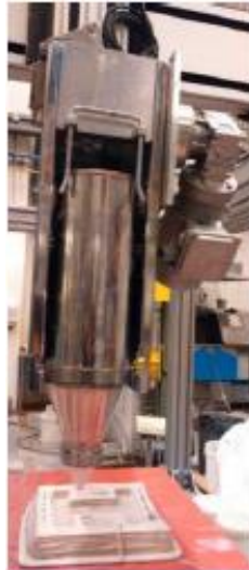
Figura 34 - Equipamento a depositar gesso, criando uma peça
