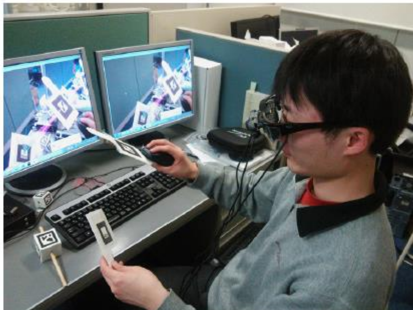
Figura 28 - A interface do sistema através dos óculos e dos marcadores de RA.
