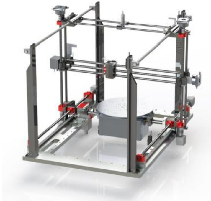
Figura 35 - Estrutura da área de impressão do equipamento final
