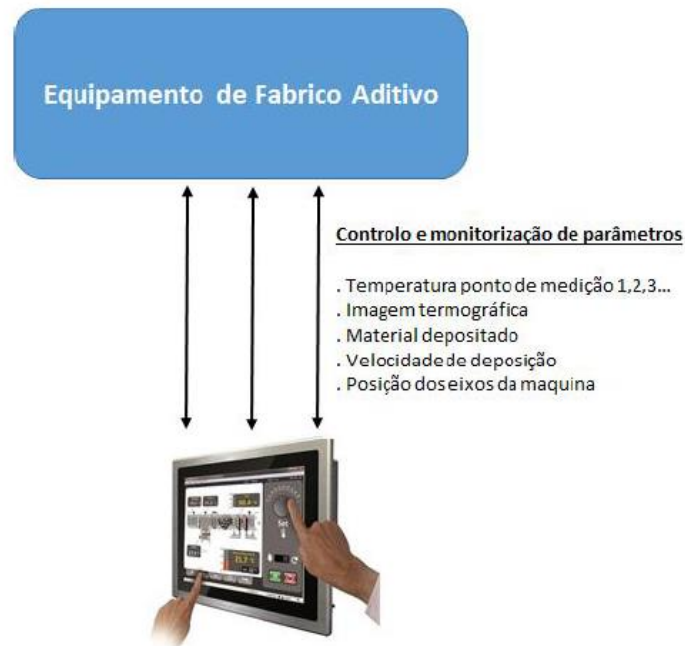
Figura 1 - HMI para Fabrico Aditivo
