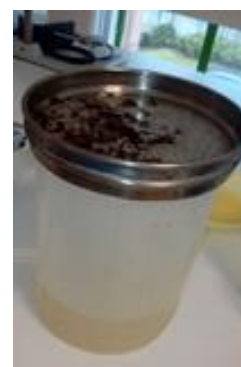
Figura 38 - Filtração do xarope, através de um crivo com 1mm de furação
