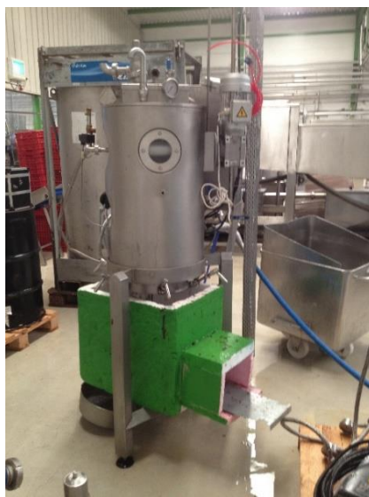
Figura 34 - Caixa de esferovite adaptada ao protótipo
