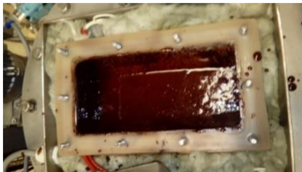
Figura 28 - Estado do doseador após ensaio com as chapas perfuradas
