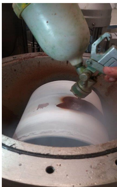
Figura 31 - Aplicação de chocolate diretamente no cilindro por uma pistola de pressão de ar
