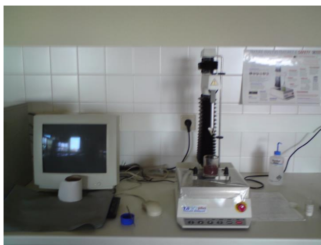
Figura 15 - Determinação da firmeza e adesividade das pastas de azeitona utilizando o analisador de textura.
