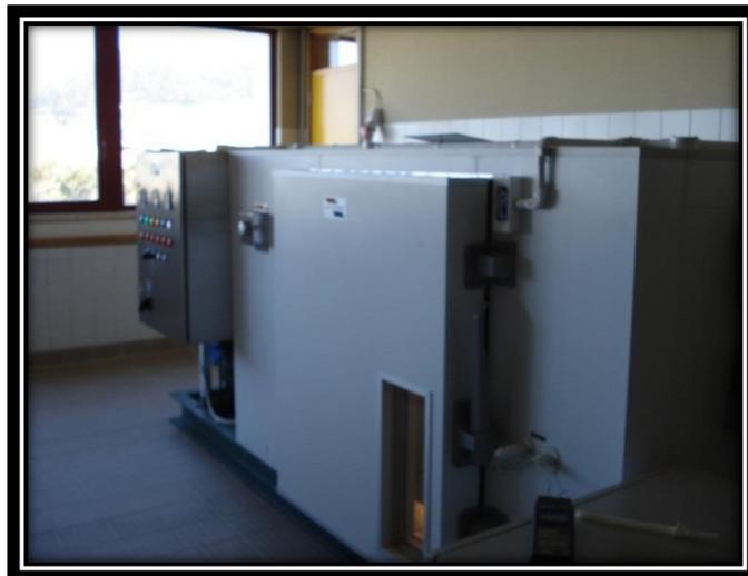
**Figura 18 – Túnel de congelação utilizado para a congelação das algas**
