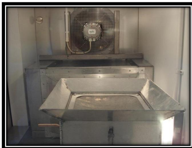
**Figura 19 - Interior do túnel de congelação utilizado para a congelação de algas**
