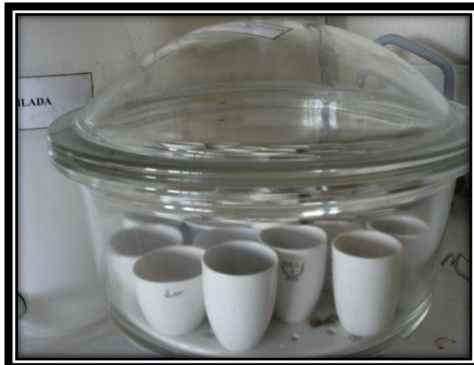
**Figura 21 – Exsicador utilizado para arrefecimento das amostras**
