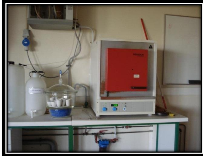
**Figura 20 – Mufla utilizada para a determinação de cinzas**
