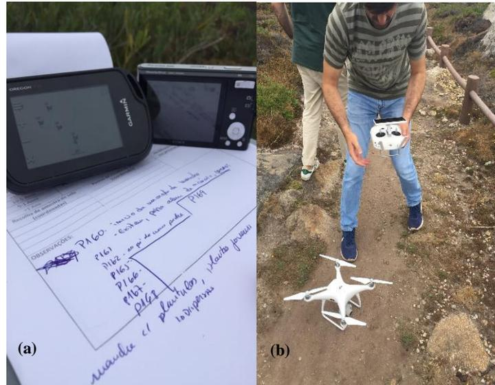
Figura 4.3 - Material de auxílio para trabalho de campo - (a) GPS – Garmin Oregon 750 e câmara fotográfica para georreferenciação das manchas de acácia e registo fotográfico; b) Drone usado para a recolha de fotografias aéreas).
