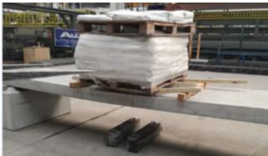
Figura 39 – Foto global do painel 4 sem fissuras
