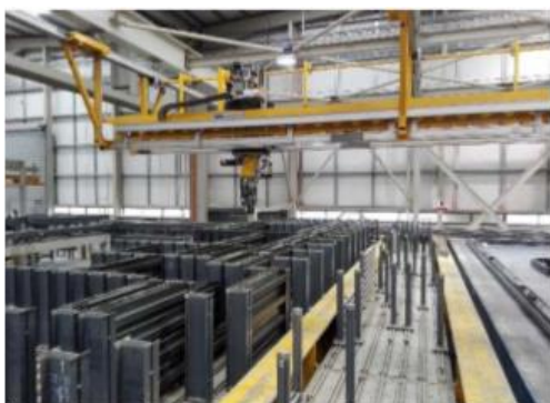
Figura 26 – Robô a escolher a cofragem de acordo com o CNC
