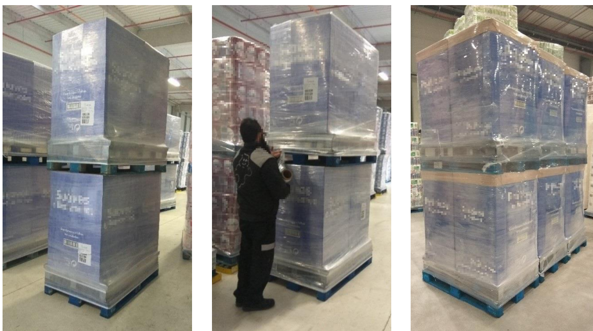
Figura 40: Processo de empilhamento e filmagem no Cais de Expedição.
