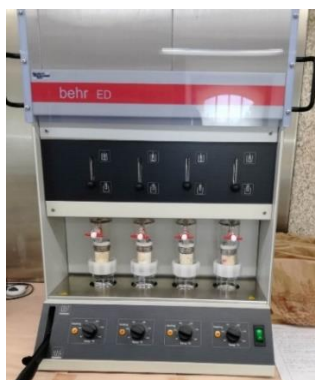
Figura 2.13. Determinação do teor de gordura das larvas.
