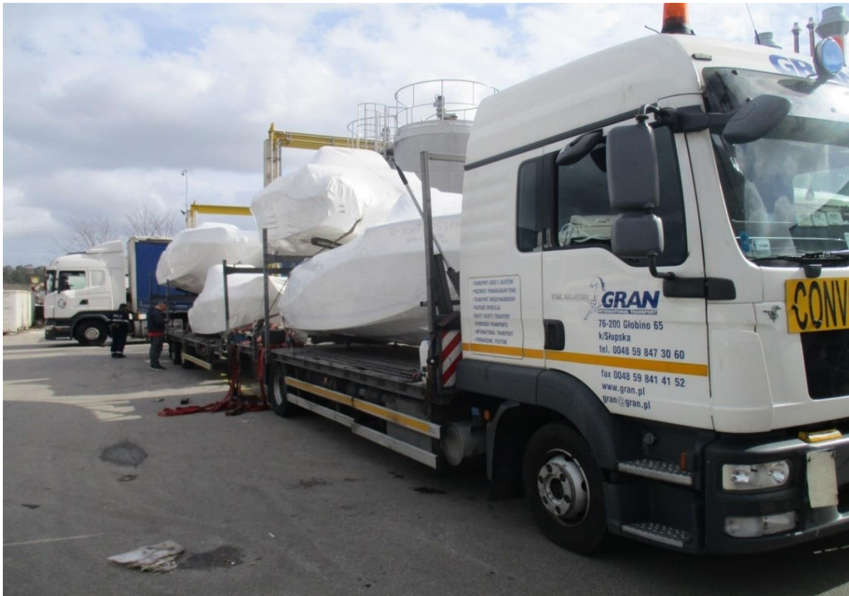
Figura 16 - Camião dedicado para transporte de barcos (Cortesia Brunswick Marine EMEA Operations)
