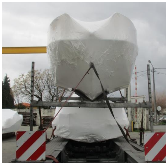
Figura 19 - Suportes utilizados para carregamento de barcos (Cortesia Brunswick Marine EMEA Operations)
