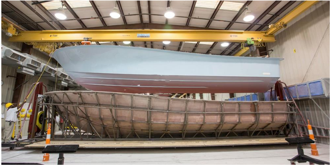
Figura 11 - Processo Mesmoldeamento barco
