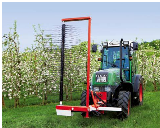
Figura 1.14 - Equipamento para a realização da monda mecânica (Fonte: www.fruittec.com )
