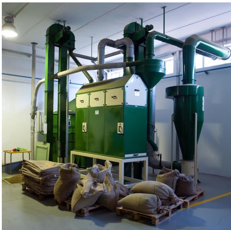
Figura 9 - Máquina de limpeza e armazenamento do café e descafeinado verde.
