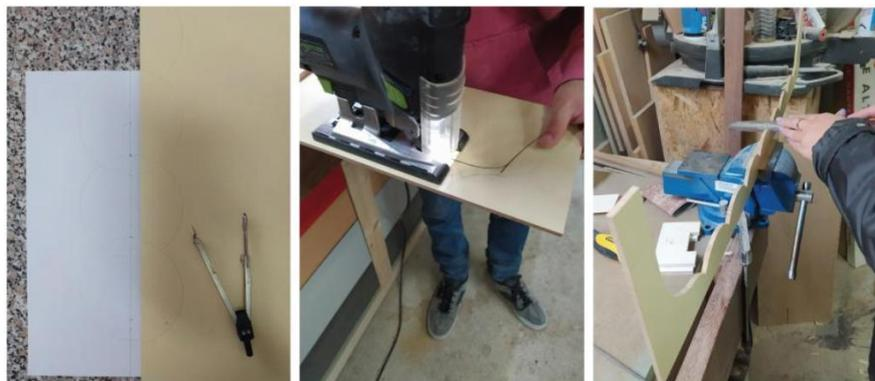
**Figura 45-** Da esquerda para a direita: **Desenho do molde em placa de 5mm. Corte do molde** com o tico-tico e lixagem com diferentes lixas. Fonte: Vanessa LIMA
