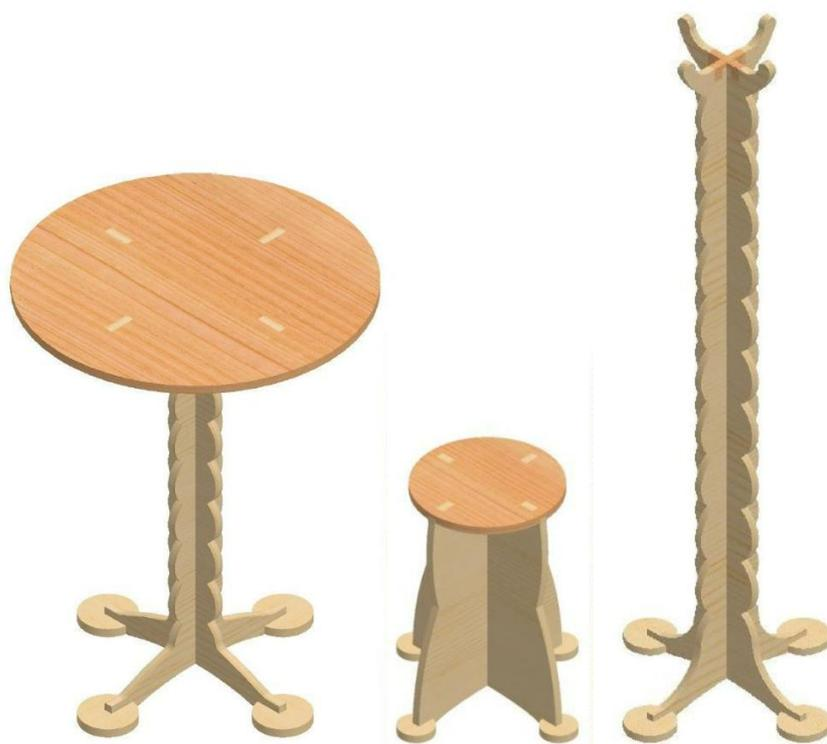
**Figura 58- Sistema de equipamento**, 3 tipologias (mesa/banco/bengaleiro), desenho 3D no programa Solidworks. Fonte: Vanessa LIMA
