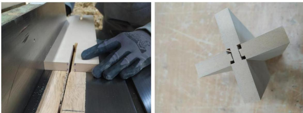
**Figura 39-** Da esquerda para a direita: Primeira tentativa de corte para a realização do **encaixe no protótipo**. Após os dois encaixes concluídos, percebeu-se que ocorreu um erro de corte numa das placas. Fonte: Vanessa LIMA
