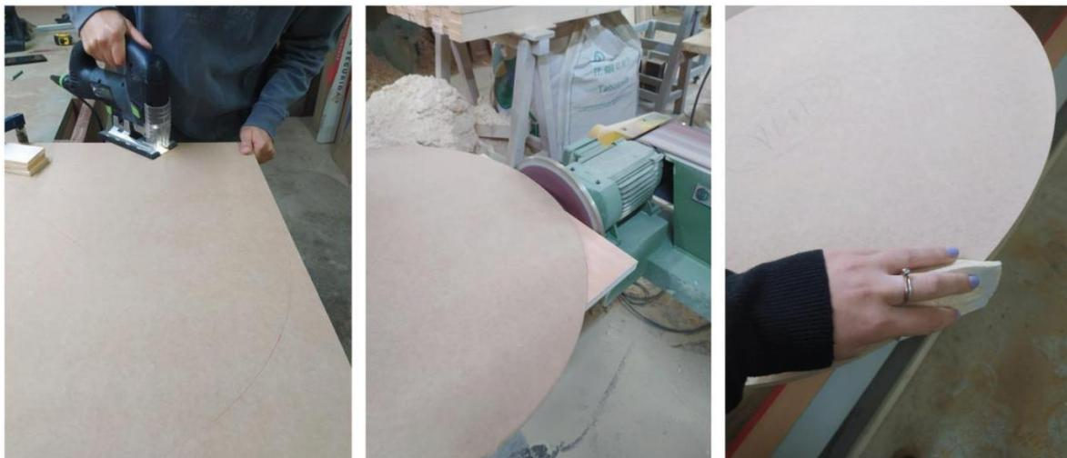
**Figura 48-** Da esquerda para a direita: Fase de **desenho do tampo da mesa** na placa de MDF e corte da mesma, com o tico-tico. **Lixagem mecânica e manual do tampo.** Fonte: Vanessa
