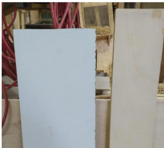
**Figura 38- Seleção do material a aplicar no protótipo.** À esquerda, placa de MDF, à direita, contraplacado de choupo. Fonte: Vanessa LIMA
