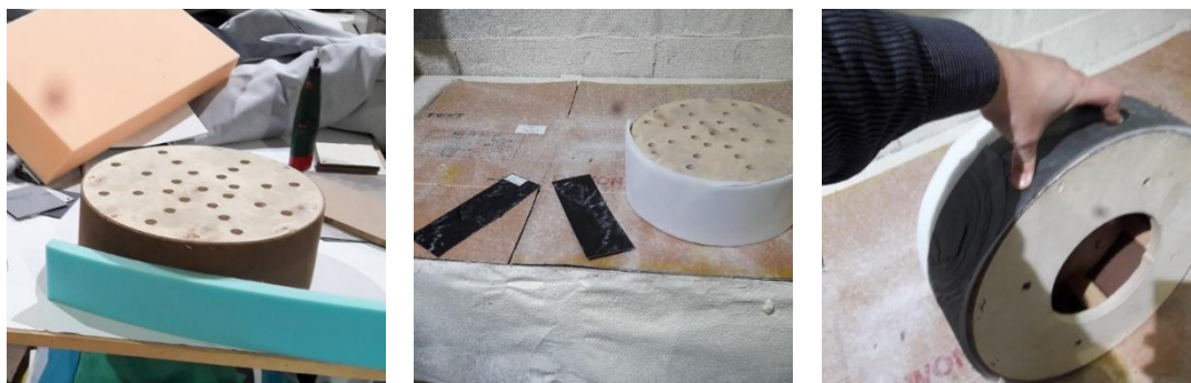
Figura 49 - Casco cilíndrico utilizado no 5º teste (à esquerda), Colagem das espumas ao casco / revestimento do casco com espuma (ao centro), Colagem e fixação da tira de folha de pedra no casco (à direita). (Casco 250mm diâmetroX120mm) Fonte 81
