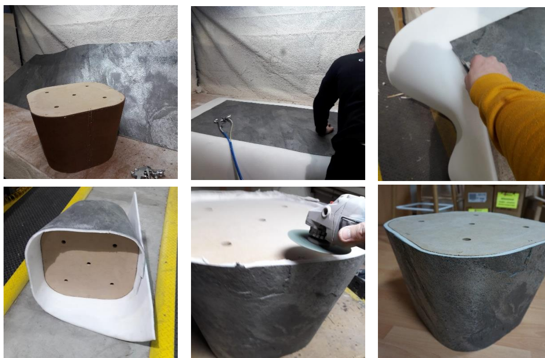
Figura 75 - Casco mush e folha de pedra na estufa de colagem (canto superior à esquerda) Colagem da folha de pedra à placa de espuma (em cima ao centro). Corte do excesso de espuma colado na traseira da folha de pedra (canto superior direito). Casco mush revestido a folha de pedra com matriz de espuma (canto inferior à esquerda). Rebarbagem dos excessos de folha de pedra com matriz de espuma (em baixo ao centro). Resultado final do teste (canto inferior direito). (Puff Mush 500mmX500mmX450mm) Fonte 116
