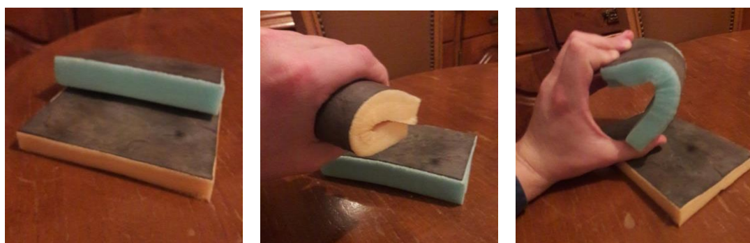
Figura 36 – Resultado do 2º teste – folha de pedra em espuma azul26 e laranja23 (à esquerda), Teste da flexibilidade da amostra do 2º teste – espuma laranja e folha de pedra (ao centro), Teste da flexibilidade da amostra do 2º teste – espuma azul e folha de pedra. (Amostras 40mmX60mmX20mm)Fonte 66
