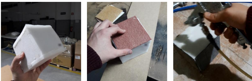
Figura 47 - Casco totalmente revestido a espuma (à esquerda), Colagem da folha de pedra a uma face do casco (ao centro), Passagem de cola na espuma do casco e na face em resina epóxi da folha de pedra para concluir o revestimento do casco (à direita). (Cubo 100mmX100mmX100mm) Fonte 79
