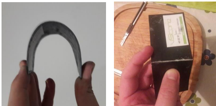
Figura 31 - Reconhecimento das propriedades do material – flexibilidade (à esquerda), Análise da estrutura interna do material composto por fibra de vidro e resina epóxi (à direita). (Amostra 80mmX30mm) Fonte 61
