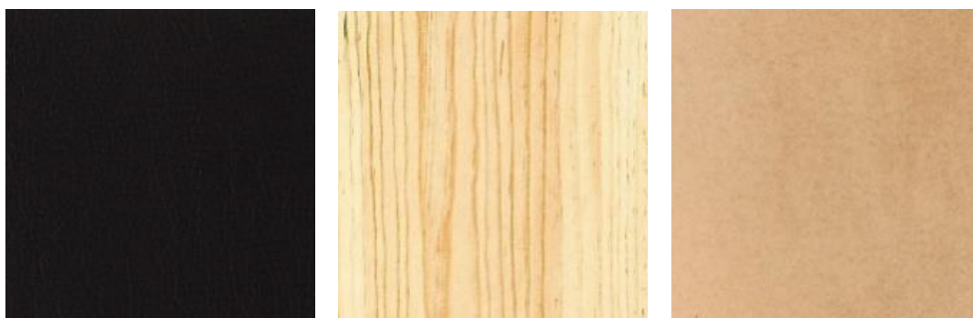
Figura 26 – Revestimento sintético, alma preto, Cat.1 (à esquerda), Madeira de Pinho (ao centro), Madeira MDF (à direita). Fonte 56
