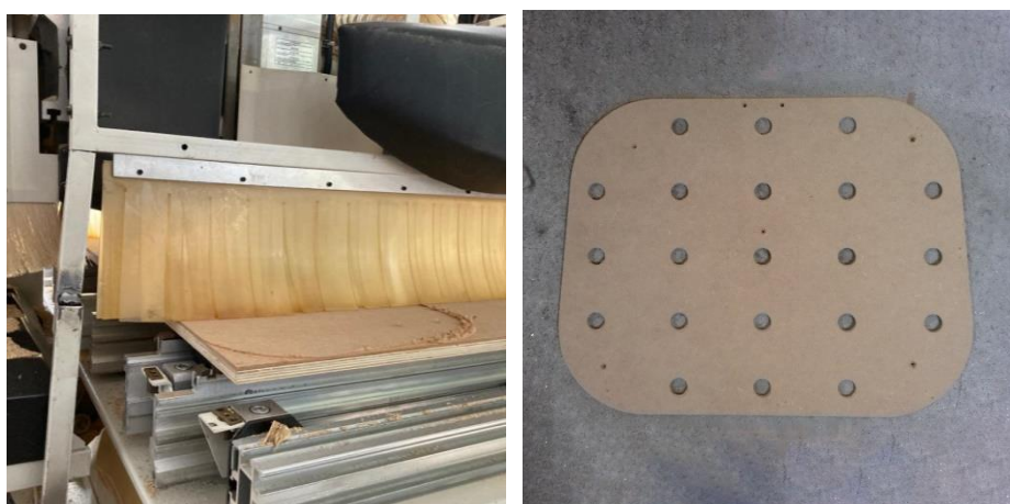
Figura 103 - Corte em CNC das estruturas do painel, base e base para as espumas. (à esquerda) Base das espumas após o corte em CNC (à direita). (Base para espuma 575mmX475mm) Fonte 147
