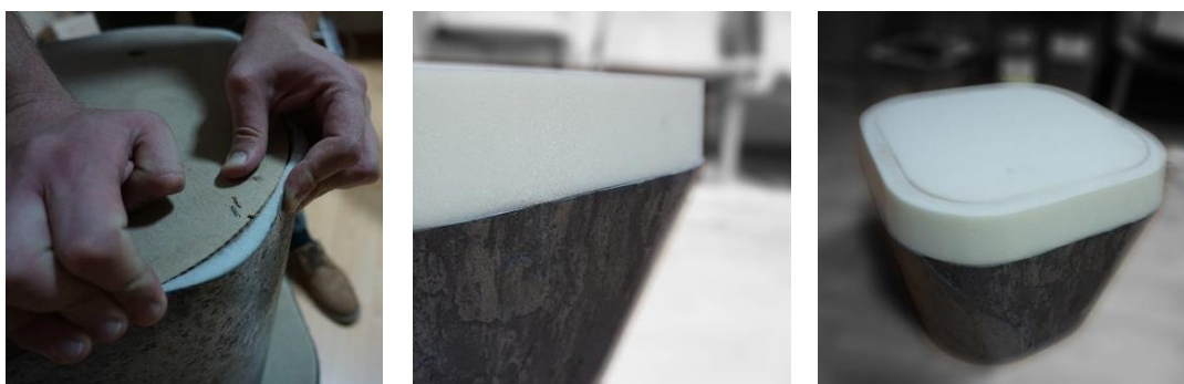
Figura 76 - Flexibilidade da folha de pedra com espuma (a baixo à esquerda), zona de interação entre a espuma e a folha de pedra (a baixo ao centro), casco revestido a folha de pedra com espuma no assento (a baixo à direita). (Puff Mush 500mmX500mmX450mm) Fonte 117
