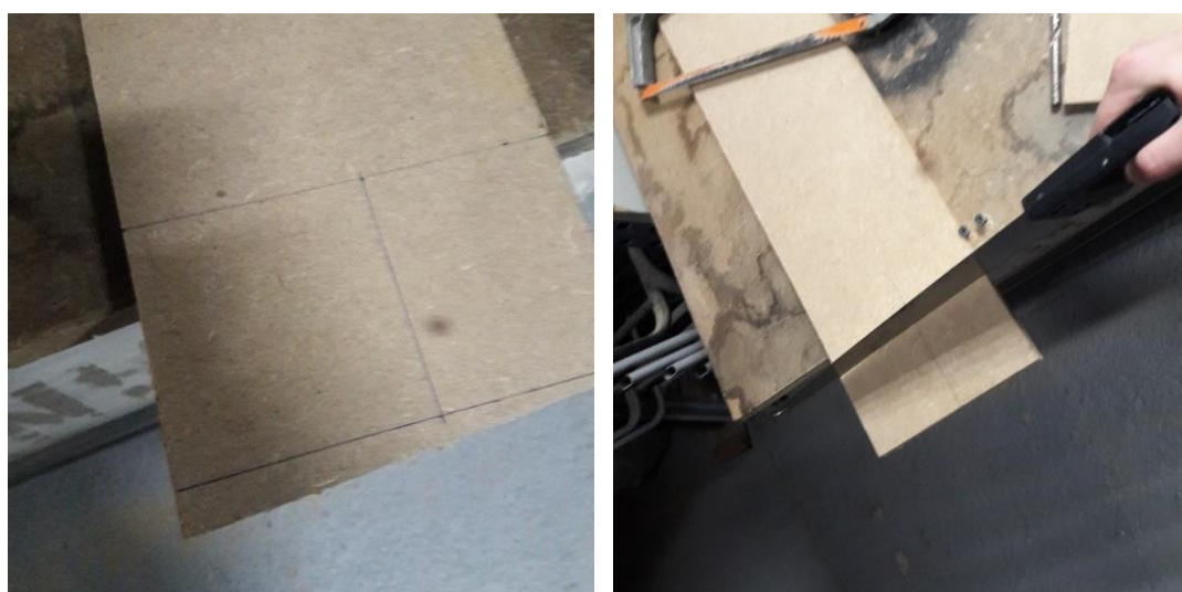
Figura 186 - Distribuição e planificação na madeira das faces que constituem o casco em forma de cubo (à esquerda). Corte das faces do cubo planificadas na madeira por meio de um serrote (à direita).
