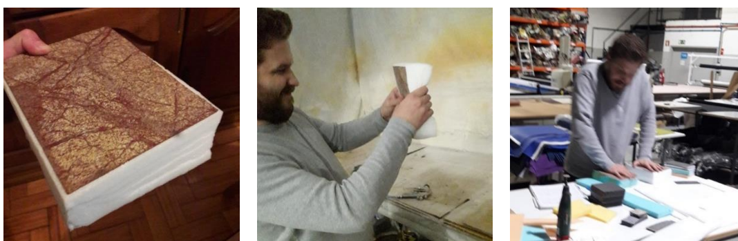
Figura 39 - Resultado final do 3º teste: folha de pedra VS27 com espuma branca super dura de 30 (à esquerda), Compressão da folha de pedra e da espuma VS27 (ao centro), Teste de pressão, flexibilidade e modelação das duas amostras (à direita). (Amostra 80mmX100mmX70mm) Fonte 69
