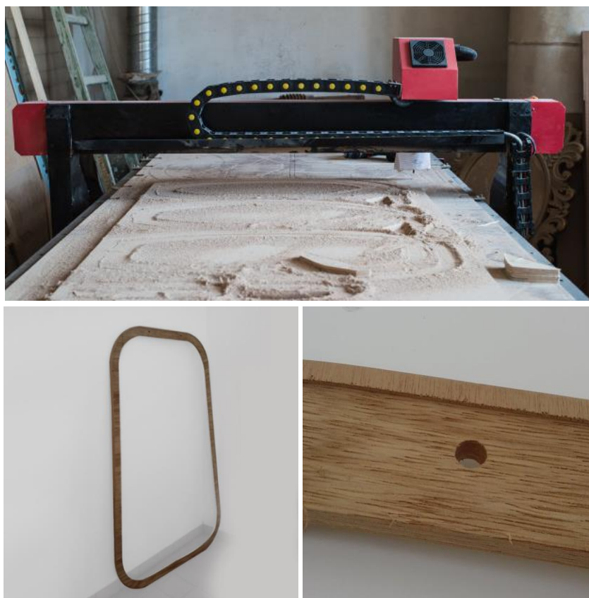
Figura 96 - Corte da estrutura dos painéis em CNC (em cima). Estrutura do painel cortado em CNC (canto inferior à esquerda). Pormenor da furação da estrutura na base e do rebaixo de 2mm a 10mm da extremidade do painel (canto inferior à direita). (Estrutura do corpo do painel com 1200mmX1800mm)Fonte 140
