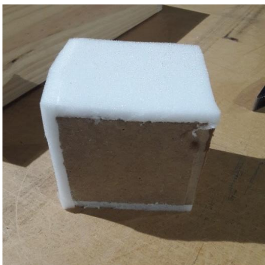
Figura 188 - Colagem da espuma no casco em forma de cubo (à esquerda) Colagem da folha de pedra sobre a espuma que reveste o casco (à direita). (Cubo com dimensões de 200mmX200mmX200mm)
