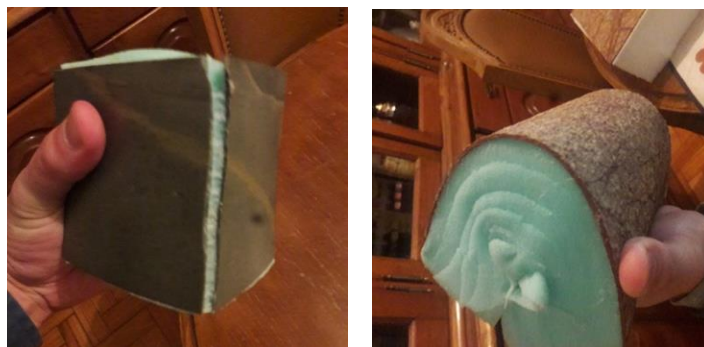
Figura 38 - Teste da flexibilidade, compressão e limites da amostra final do teste com a folha VS07. Pouco resistente (à esquerda), - Teste da flexibilidade, compressão e limites da amostra final do teste com a folha VS27. Boa resistência. (à direita). (Amostra 80mmX100mmX70mm) Fonte 68
