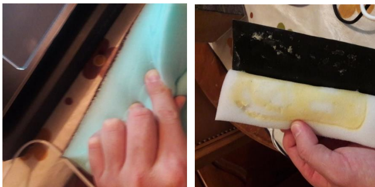
Figura 34 - Resultado final da colagem da espuma à folha de pedra com cola branca – Resultados positivos (à esquerda), Resultado final da colagem da espuma à folha de pedra com cola amarela - Resultados negativos (à direita). Fonte 64
