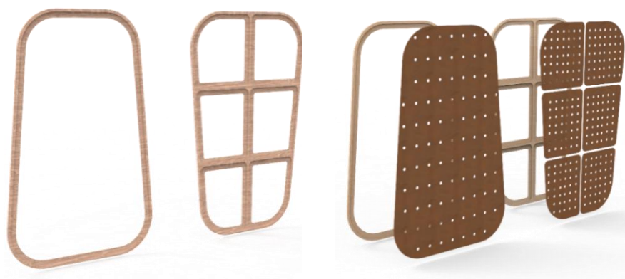
Figura 87 -1º Passo – Preparação das estruturas (à esquerda). 2º Passo – Preparar bases para espumas em painéis de madeira micro-perfurado (à direita) (Painel 1000mmX1500mm). Fonte 129
