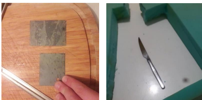
Figura 32 – Amostras de folha de pedra (à esquerda), corte da espuma por medida com uma faca com ponta aquecida (à direita). (Amostra 40mmX30mm) Fonte 62
