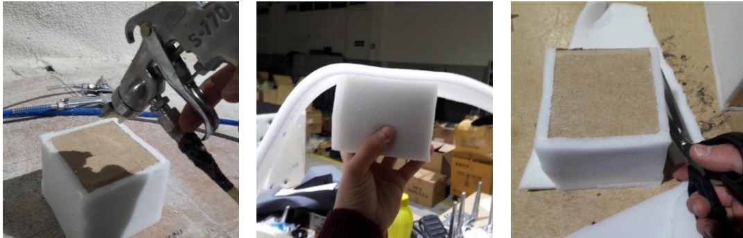
Figura 46 - Passagem de cola na face do casco em madeira para revestir com espuma em falta (à esquerda), revestimento do casco com excesso de espuma (ao centro), Corte do excesso de espuma que reveste o casco (à direita). (Cubo 100mmX100mmX100mm) Fonte 78
