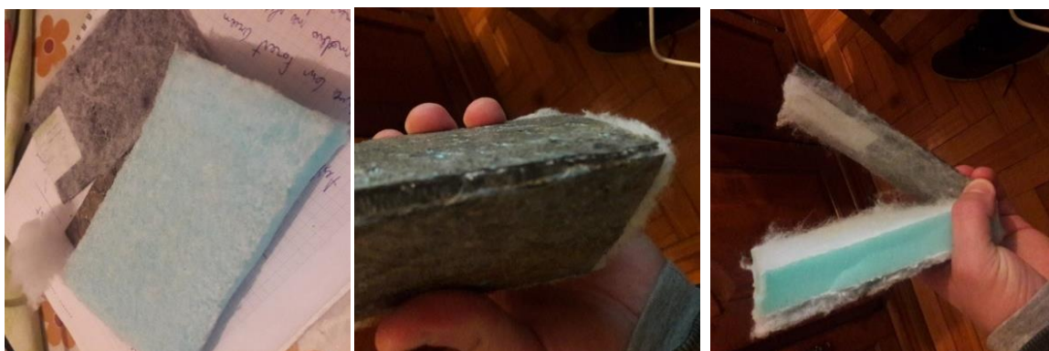
Figura 44 - Inconformidade da amostra: a folha de pedra rasga facilmente a sua ligação com a plumanta (à esquerda), Folha de pedra levada ao limite do seu ponto de rotura (ao centro), Amostra totalmente danificada (à direita). Fonte 75
