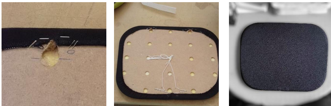
Figura 113 - Apontamento do tecido com agramos para melhorar o ajuste do tecido ao painel (canto inferior à esquerda). Corpo do painel totalmente estofado voltado para baixo (canto inferior direito). Corpo do painel totalmente estofado voltado para cima (canto superior direito). (Base para espuma 575mmX475mm) Fonte 158
