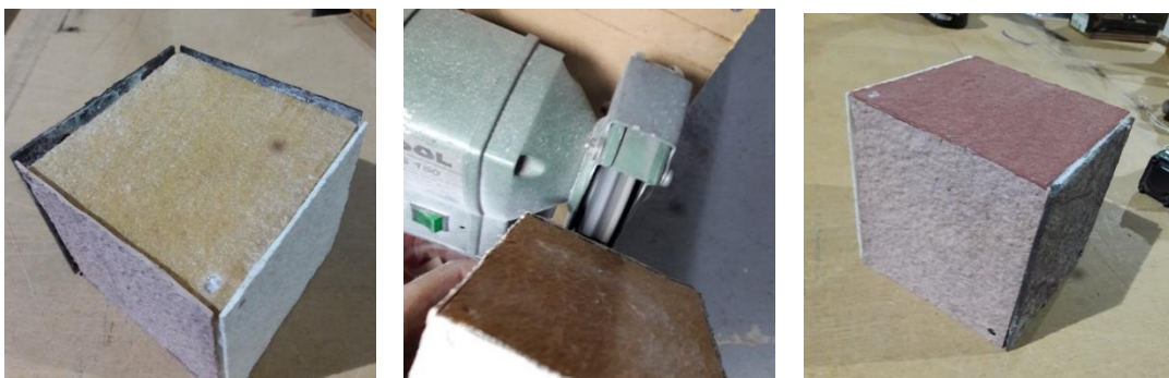
Figura 48 - Casco totalmente revestido a folha de pedra (à esquerda), Aparar os excessos de folha de pedra com tornilho para acertar as arestas (ao centro), Resultado final do 5º teste (à direita). (Cubo 100mmX100mmX100mm) Fonte 80
