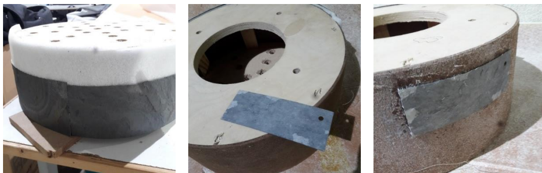
Figura 50 - Resultado final do 5º teste no casco cilíndrico (zona da emenda entre as folhas de pedra) (à esquerda). Colagem direta da folha de pedra ao platex do casco (ao centro), Resultado da colagem direta da folha de pedra no platex (à direita). (Casco 250mm diâmetroX120mm) Fonte 82
