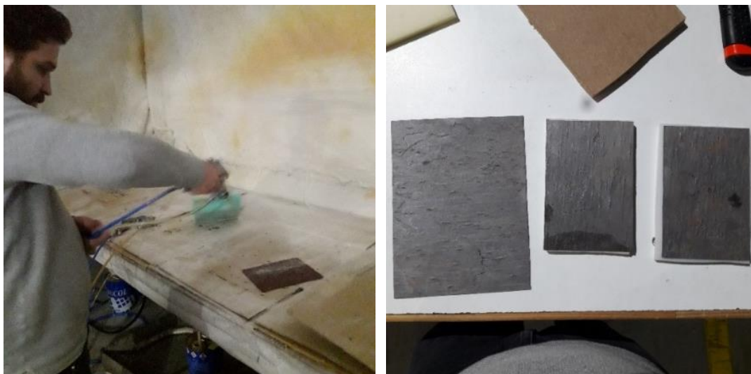
Figura 33 - Passagem da cola pelas faces da folha de pedra e da espuma (à esquerda), Resultados do primeiro teste: Folha de pedra colada à espuma (à direita). (Amostra 60mmX80mm) Fonte 63
