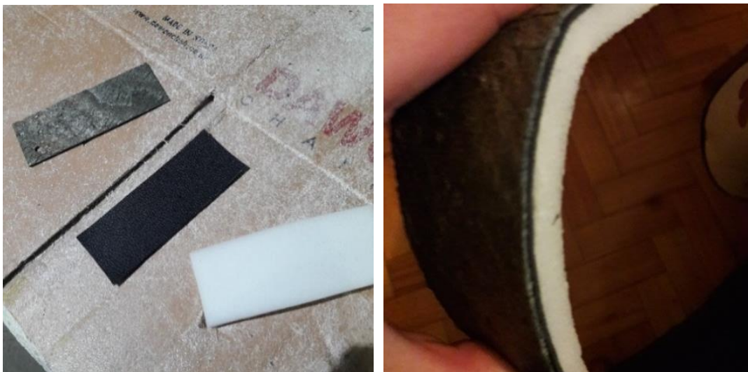
Figura 42 - Materiais utilizados para o 4º teste - Folha de pedra, tecido e espuma (à esquerda), Resultado do 4º teste (à direita). (Amostra 30mmX80mm) Fonte 72
