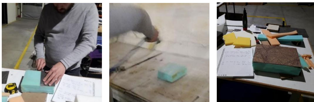
Figura 37 - Corte da espuma por medida (à esquerda), Passagem de cola na face da espuma e da folha de pedra (ao centro), Resultado final do 3º teste: Folha de pedra VS27 com espuma azul de 26 (à direita). (Amostra 80mmX100mmX70mm) Fonte 67
