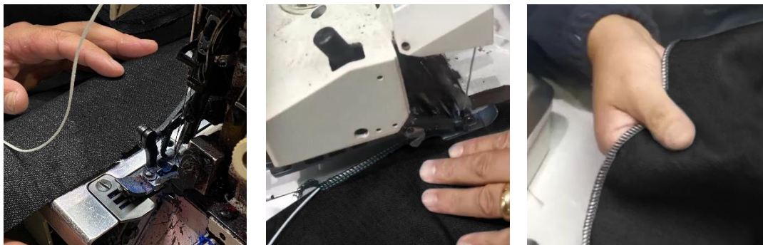
Figura 111 - Cordão de algodão pertencente ao atilho e marca de início da aplicação do atilho no tecido acústico do painel (à esquerda) Início da Aplicação do atilho (ao centro) Atilho aplicado em todo o contorno do tecido acústico (à direita). Fonte 155
