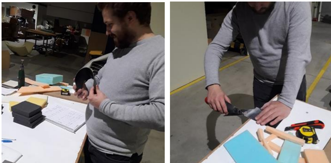
Figura 35 - Teste da flexibilidade da folha de pedra selecionada para o 2º teste (à esquerda), corte da folha de pedra por medida (à direita). Fonte 65
