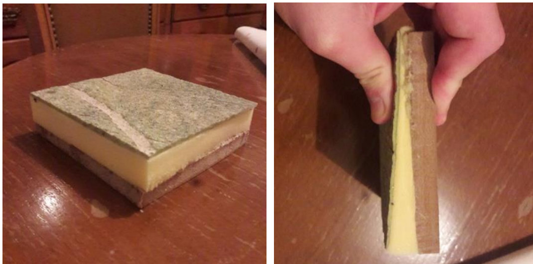
Figura 41 - Amostra do resultado do 4º teste (à esquerda), Teste da pressão na amostra (à direita). (Amostra 80mmX80mmX30mm) Fonte 71
