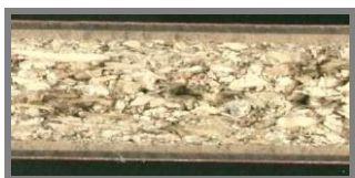
fig.19 – Detalhe de corte de placa de termolaminado
