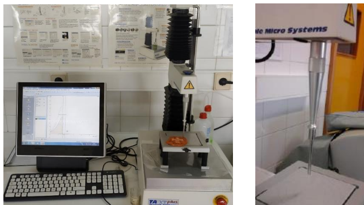
Figura 16 - Texturómetro TA.XT. plus e Sonda Cylinder Probe P/4
