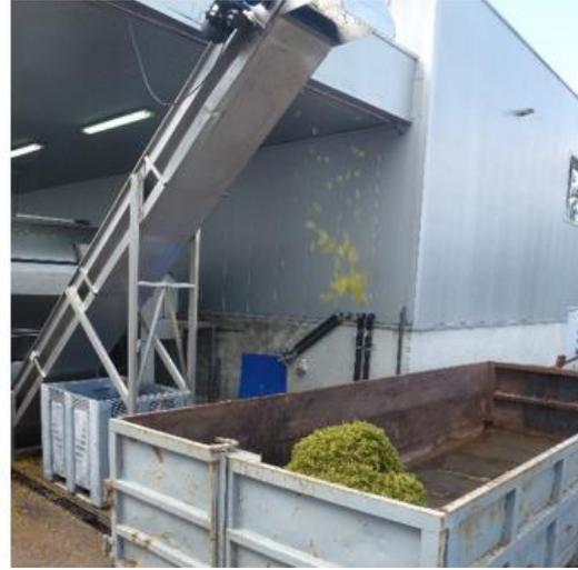
Figura 2.1. (a) Transporte do engaço após o desengaçamento, (b) recolha do engaço com as películas e as grainhas no mesmo contentor.
