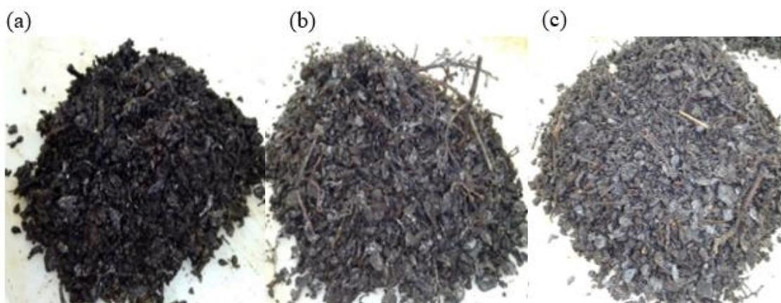
Figura 2.3. Amostras dos compostos finais das pilhas: (a) estática; (b) com 3 revolvimentos; e (c) com 6 revolvimentos após 140 dias de compostagem.
