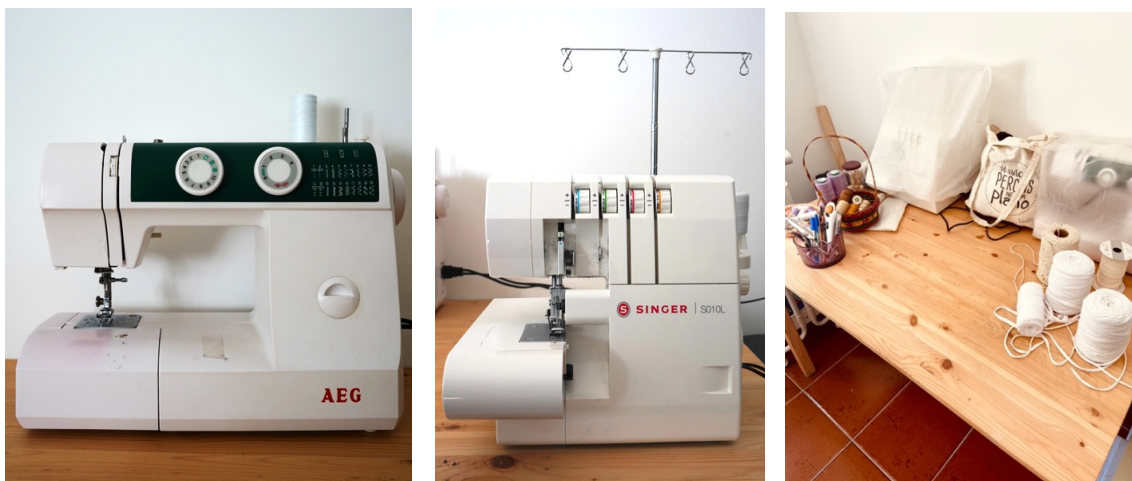
Figura 60- Da esquerda para a direita: Máquina de costura ponto-corrido; Máquina de costura corte-e-cose; Espaço de costura. Fotografia: Raquel Gonçalves.
