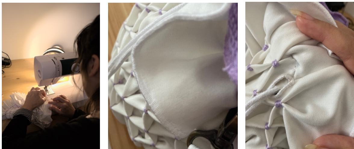
Figura 67- Da esquerda para a direita: Coser o fundo ao padrão; Acabamento de cerzir da aresta do topo; Casear manual da casa para os atilhos. Fotografias: Raquel Gonçalves.
