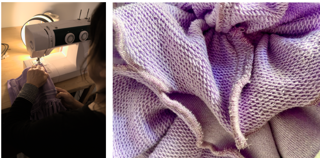
Figura 76- Da esquerda para a direita: União das laterais. Fotografia Acabamento (cerzido ponto junto) na zona de costura dos folhos. Fotografias: Raquel Gonçalves.
