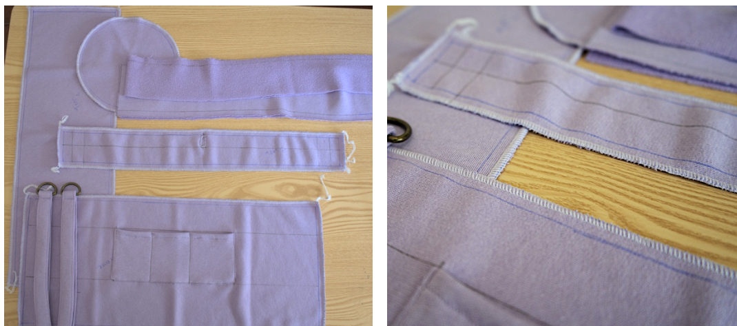
Figura 70- Da esquerda para a direita: Moldes cerzidos; Detalhe do ponto normal da máquina corte-e-cose (cerzido). Fotografias: Raquel Gonçalves.
