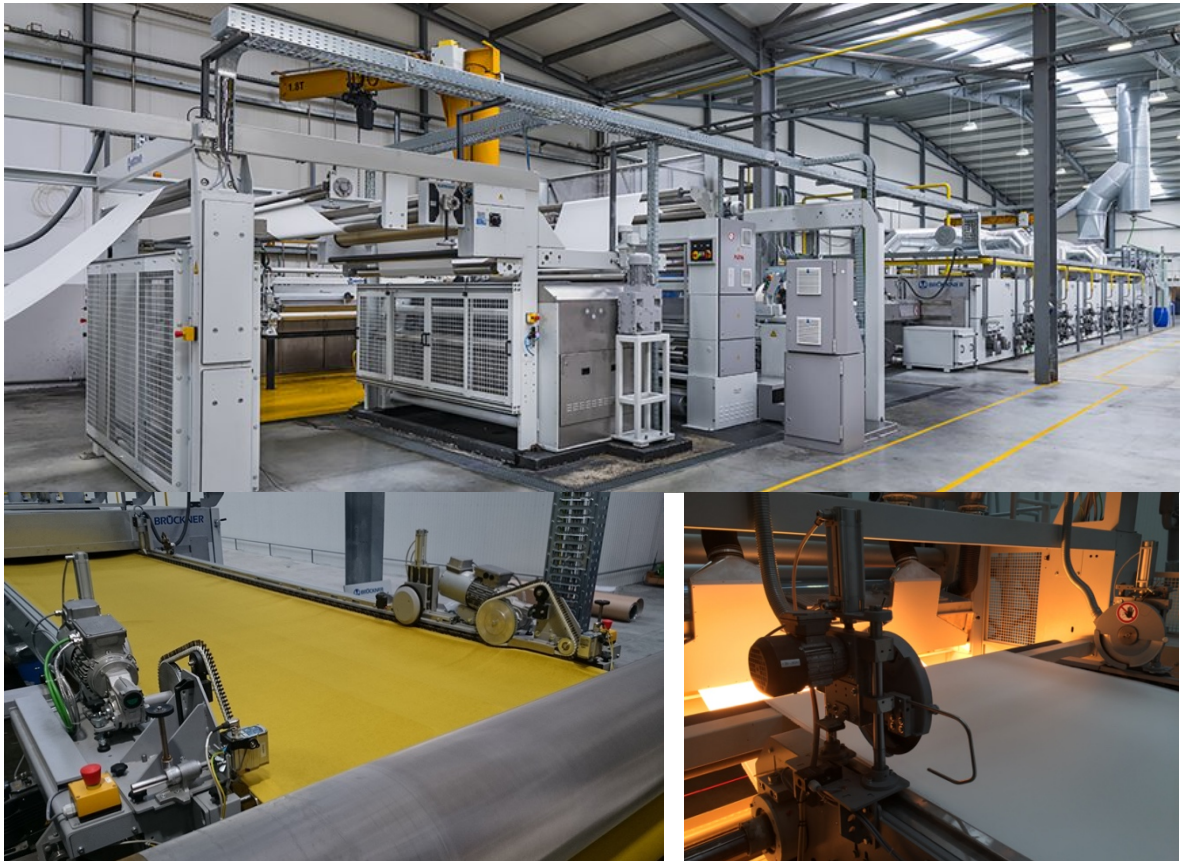
Figura 20- De cima para baixo e da esquerda para a direita: Nova linha de produção da empresa Tintex Textiles com equipamento da empresa Brückner Textile Technologies GmbH & Co. Fotografia: Website Innovation in Textiles; Equipamento de Revestimento de diversos tipos de malha. Fotografia: Innovation in Textiles; Máquina Secador infravermelho na saída da máquina. Fotografia: Innovation in Textiles. FONTE: https://www.innovationintextiles.com/no-sustainability-without-innovation-for-tintex-and-brckner/ (acedido a 14/05/2022)
