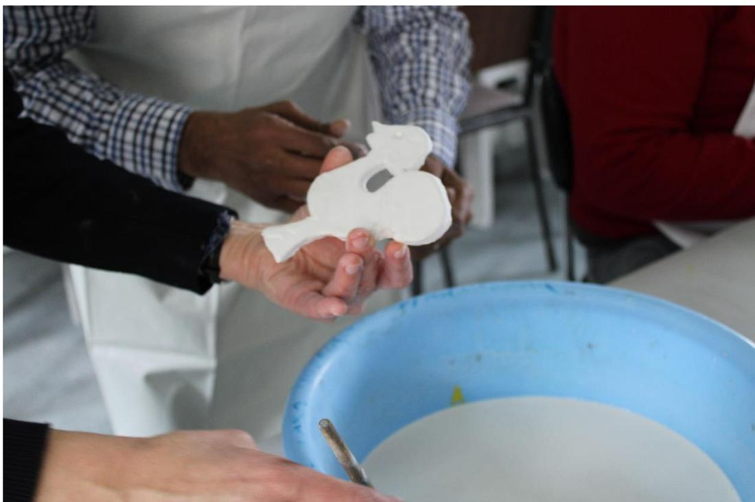
Fig. 27- Processo de vidragem das peças por imersão. ©Santos, 2023.
