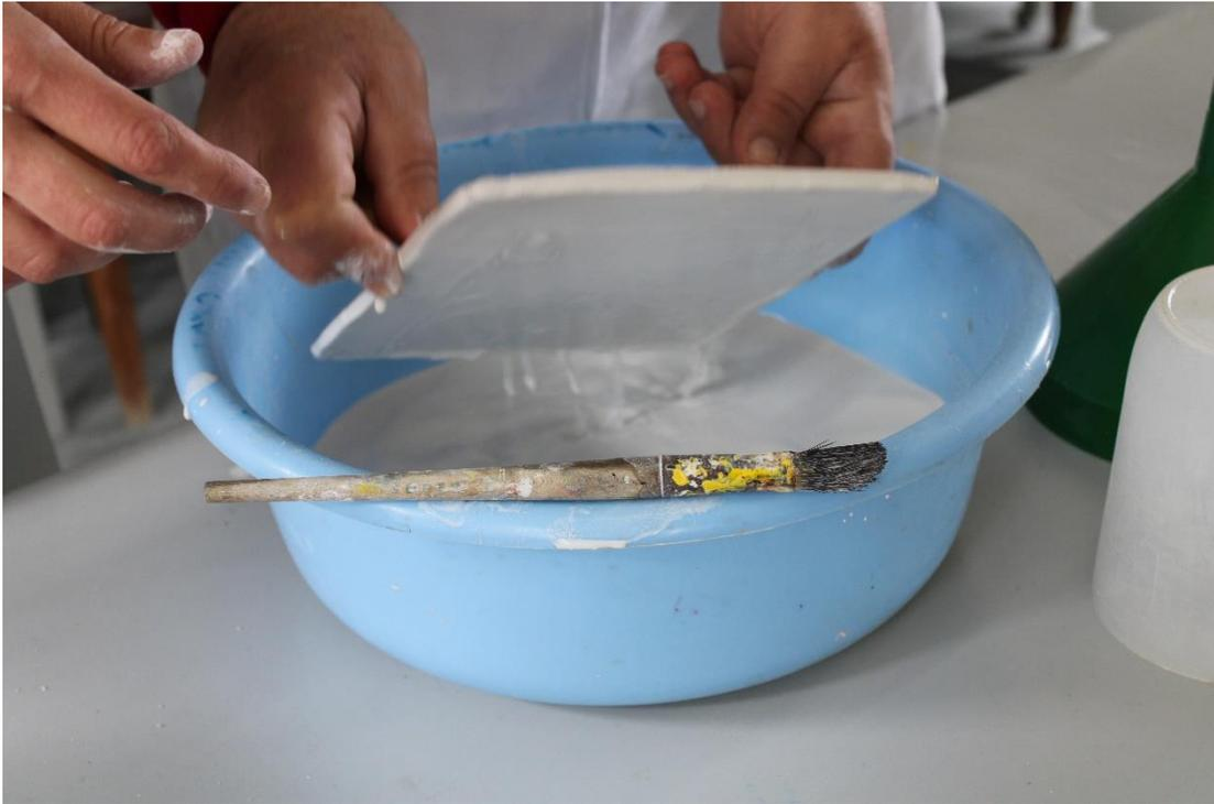
Fig. 28- Processo de vidragem das peças por imersão. ©Santos, 2023.
