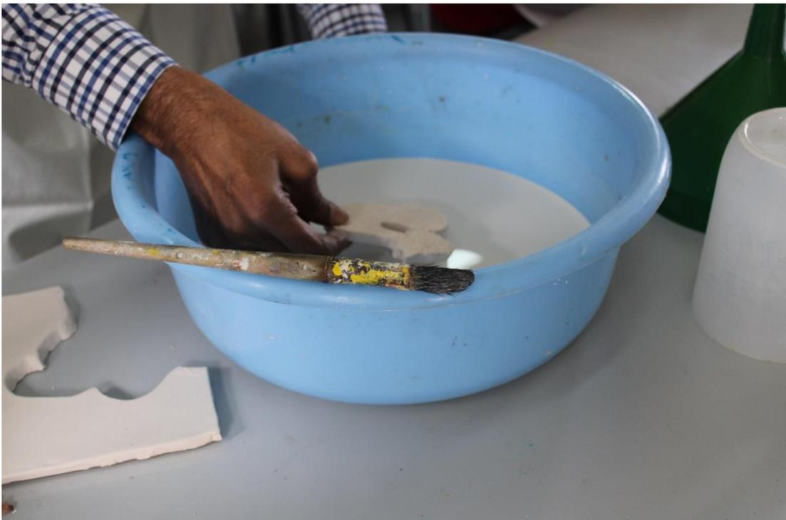
Fig. 5- Vidragem por imersão da peça chacotada. ©Santos, 2023.
