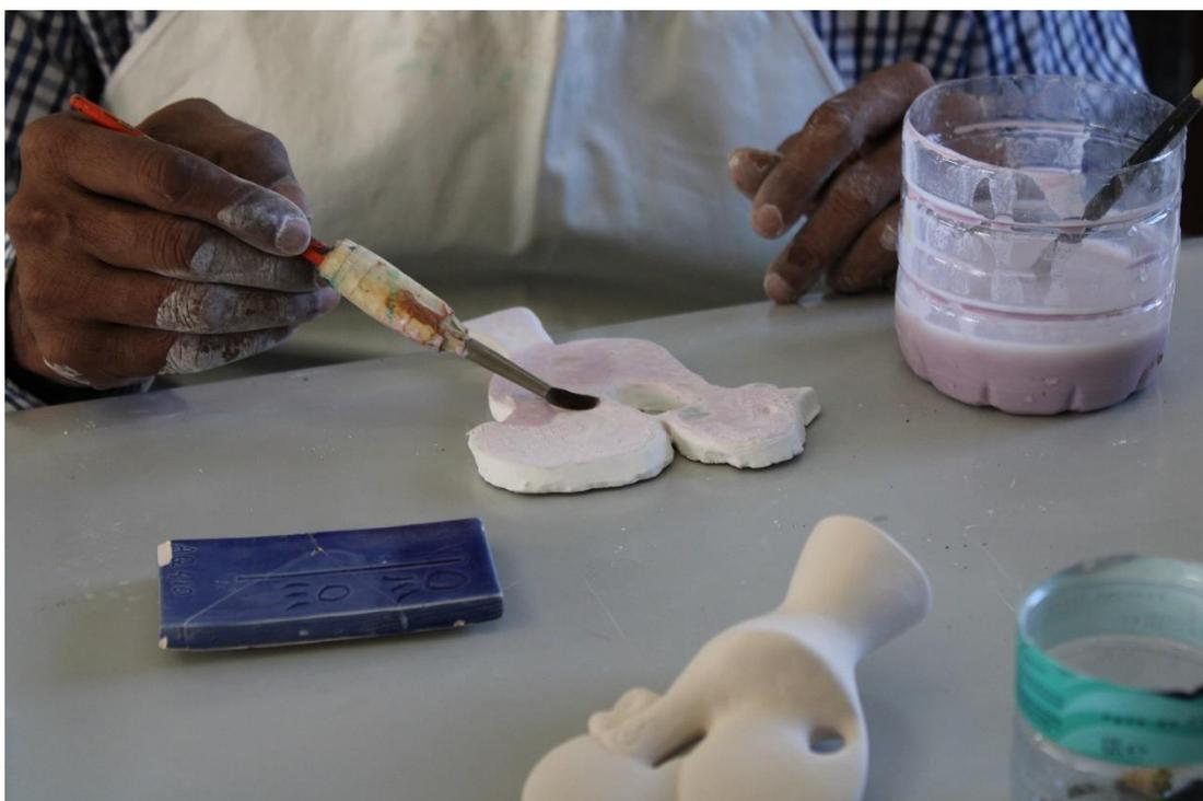
Fig. 6- Vidragem com auxílio de um pincel. ©Santos, 2023.
