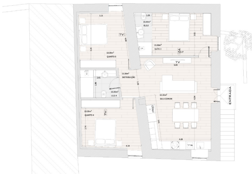
Figura 11 - Planta Piso 1 Desenho técnico da solução proposta (sem escala) desenvolvido pelo mestrando
