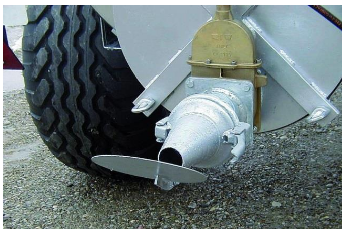
Figura 2 - Dispositivo de projeção do efluente pecuário nas tradicionais cisternas de transporte e distribuição de efluente pecuário (Tamm et al. , 2016).
