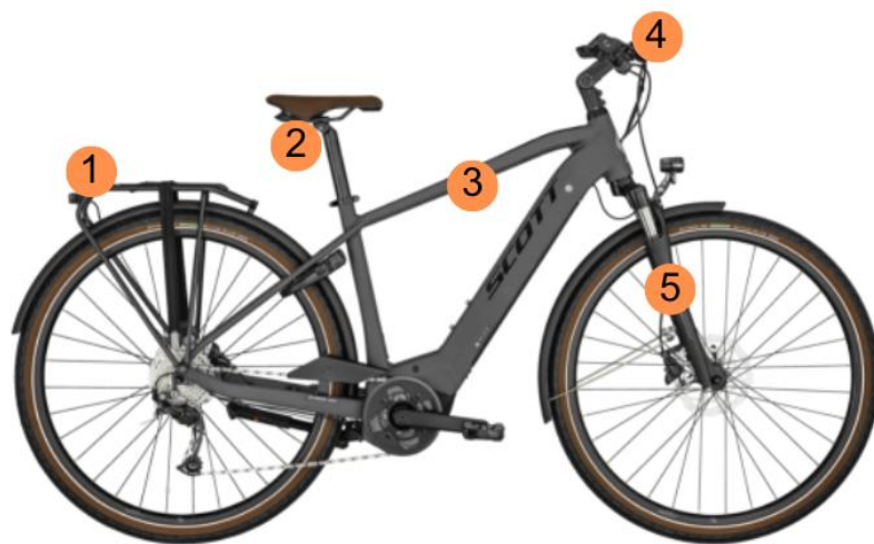
Figura 26- Locais para fixação de mochilas: Suporte traseiro (1); Assento (2); Quadro da bicicleta (3); Guidador (4); Garfo. Ilustração da autora
