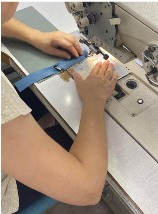
Figura 90 -Da esquerda para a direita: Colocação do fecho. Resultado do fecho exterior. Fotografias da autora.
