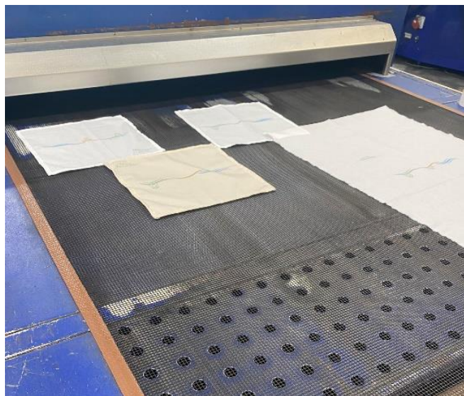
Figura 102- Secagem da tinta impressa no guardanapo. Fotografia da autora.
