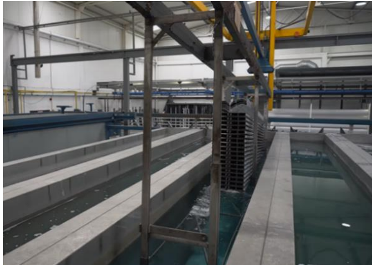
Figura 22. Processo de lacagem. Fonte: https://www.nfi.pt
