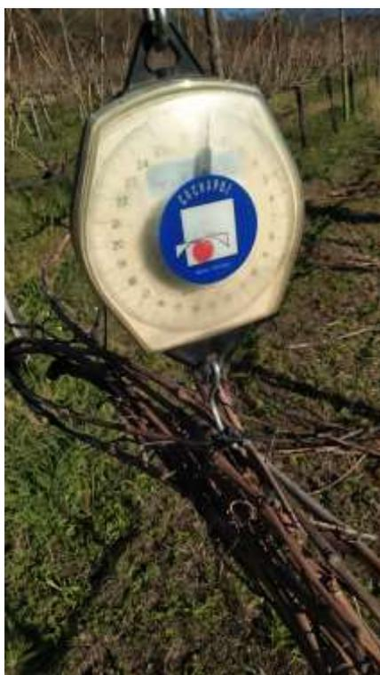
Figura 2.11: Balança dinamómetro utilizada para as pesagens do estudo.
