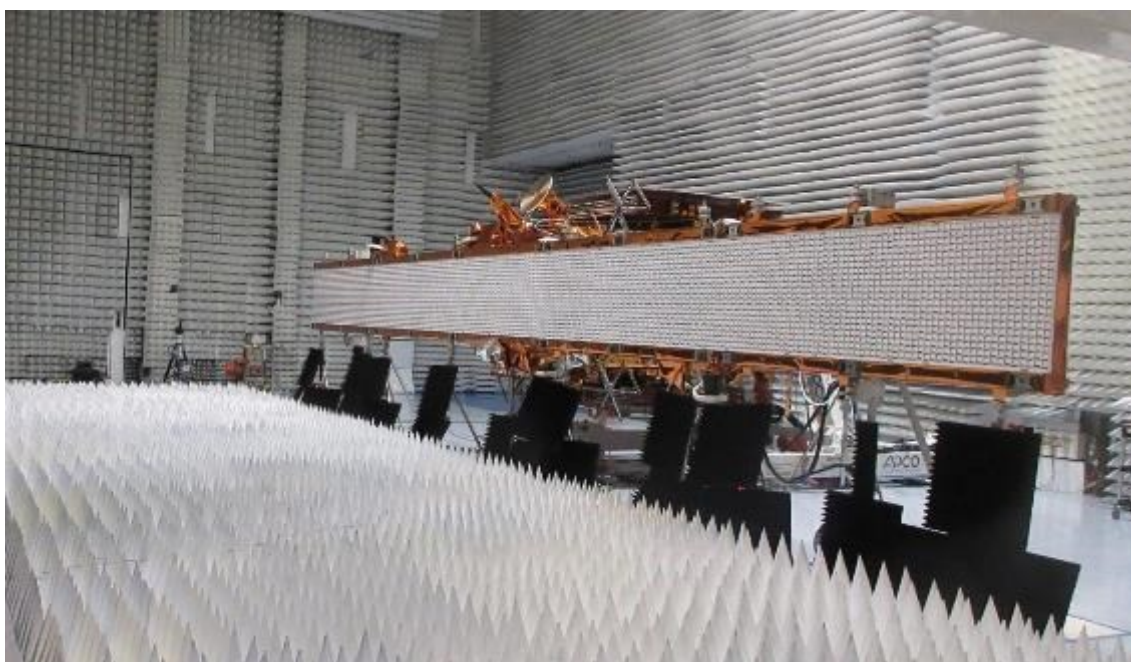
Figura 2.29 - Sentinel-1C em testes de radiofrequências na camara anecoica nas instalações da Thales Alenia Space em Cannes, França. Fonte:(ESA, 2023b)
