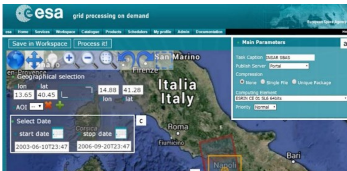
Figura 2.25 - Porta Web da ferramenta P-SBAS. Em (a) Parâmetros gerais de processamento (b) Mapa com seleção de AoI( Area of interest). Fonte:(Luca et al., 2015)
