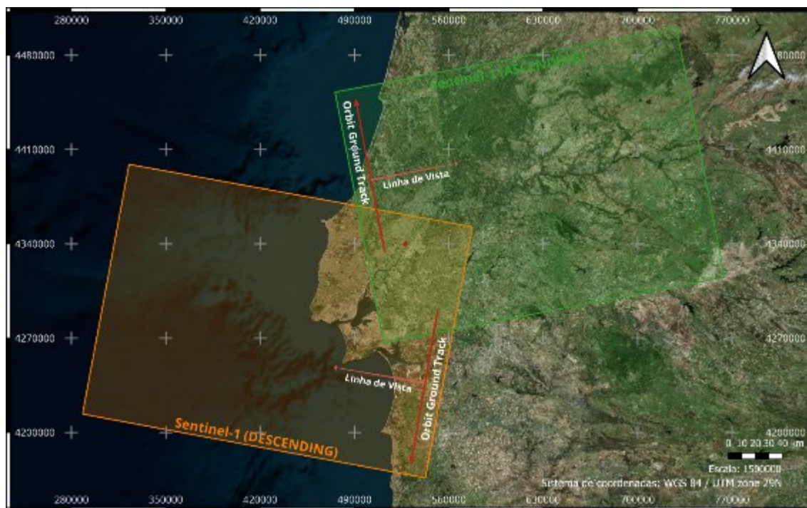
Figura 5.7 - Geometria das imagens radar para trajetória ascendente (a verde) e descendente (a cor de laranja) sobre as duas pontes de Santarém em estudo.
