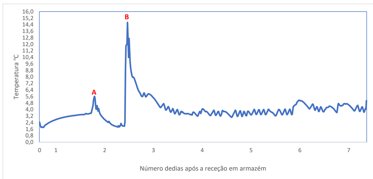
Figura 4. 1: Registo de temperatura ao longo do tempo (A – pico registado um dia após a receção em armazém; B – Pico registado dois dias após a receção em armazém).
