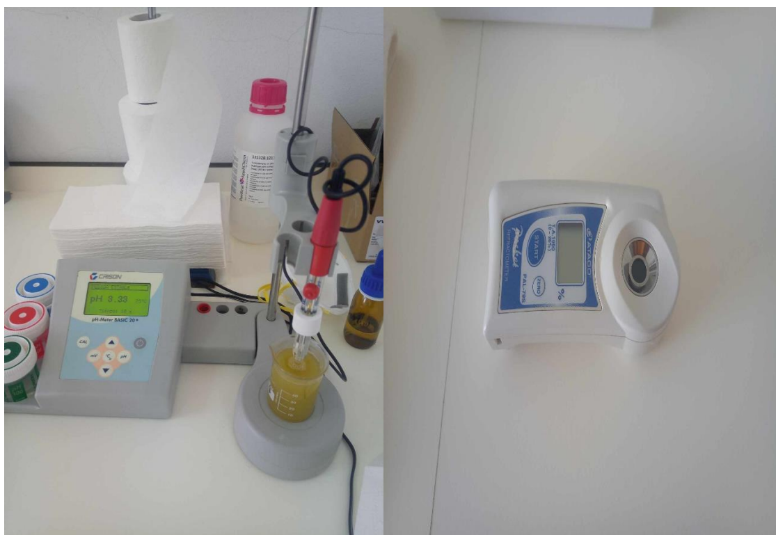
Figura 2.11- Imagem à esquerda: potenciômetro, Imagem à direita: refratômetro.
