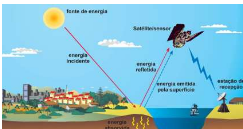
Figura 2.5. Interação sol, superfície terrestre e sensor do satélite (Fonte: Albuquerque 2012).
