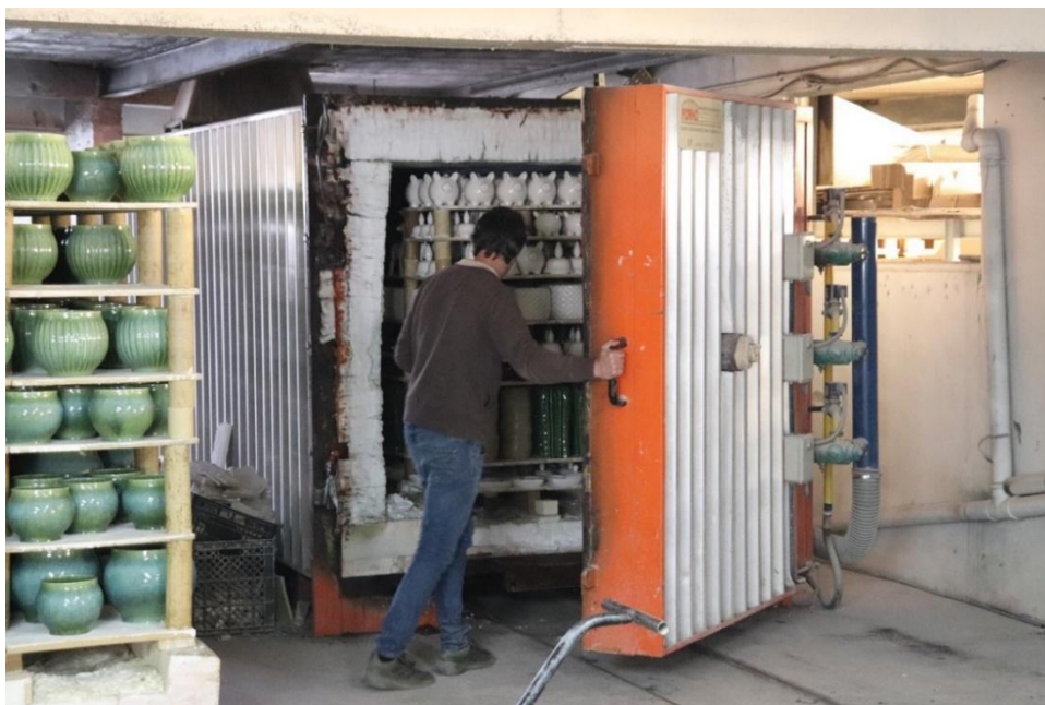
Figura 18: Momento de abertura do forno após cozedura do vidro. Fonte: Paulo SILVA.
