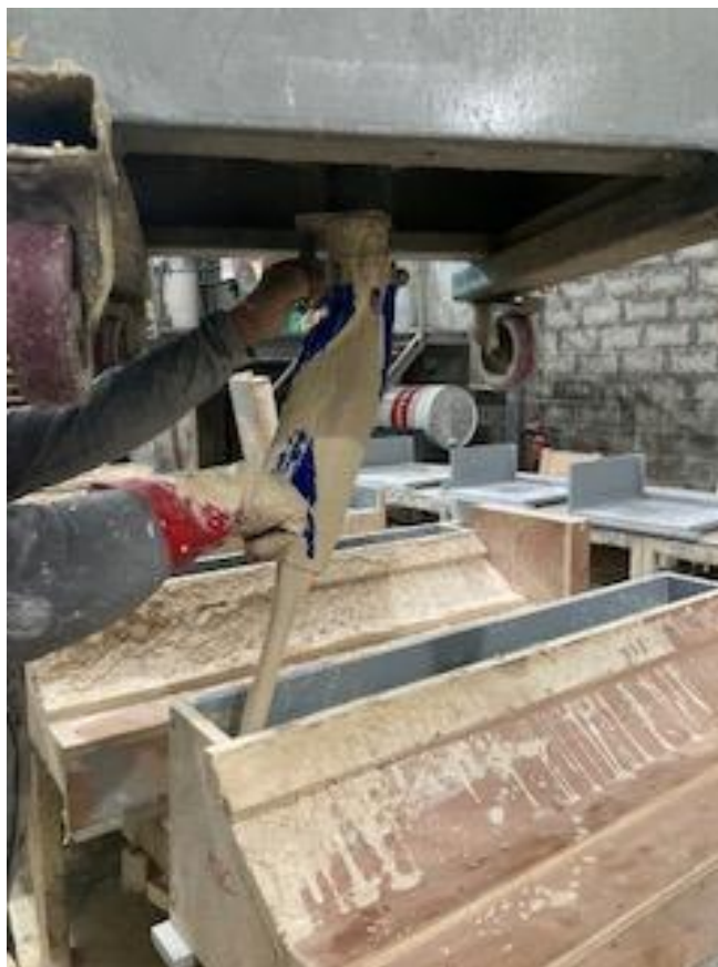
Figura 10 – Enchimento dos Moldes. Fonte: António Ribeiro.
