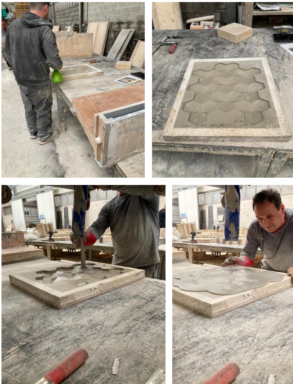
Figura 17 – De cima para baixo: Lavagem do molde. Enchimento do molde. Fonte: António Ribeiro.
