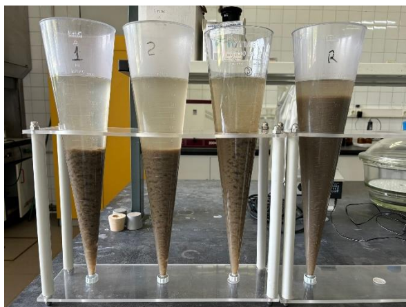
Figura 3.2. Cones utilizados para medição do V30 nos 3 tanques de arejamento e na recirculação.
