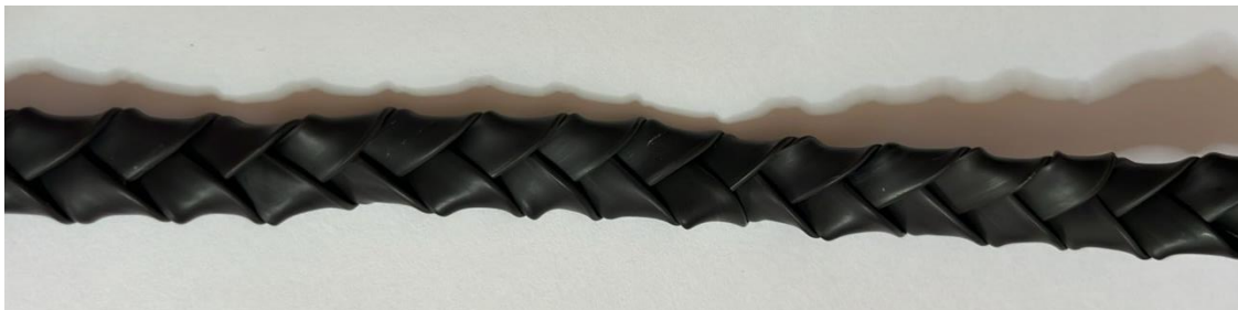
Figura 40: Fio Preto Externo do Cabo (Efeito de Pele Resistente). Fonte: Andreia Batista
