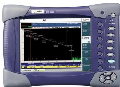
Figura 16: OTDR (Optical Time Domain Reflectometer). Fonte: dstelecom
