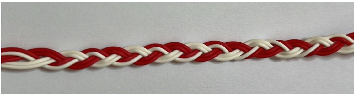
Figura 41: Junção de fio kevlar e fio de fibra ótica. Fonte: Andreia Batista
