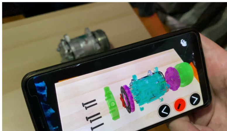
Figura 3.10: Utilização do sistema "MARMA" na manutenção de uma peça automóvel [42].
