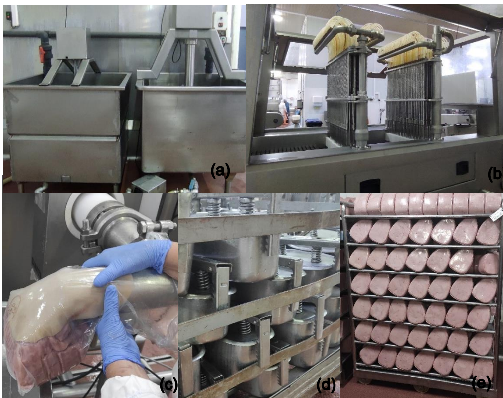
Figura 7. Processo produtivo do fiambre da perna: salmoura (a), injeção (b), enchimento (c), moldagem (d), armazenamento em câmara de refrigeração (e).
