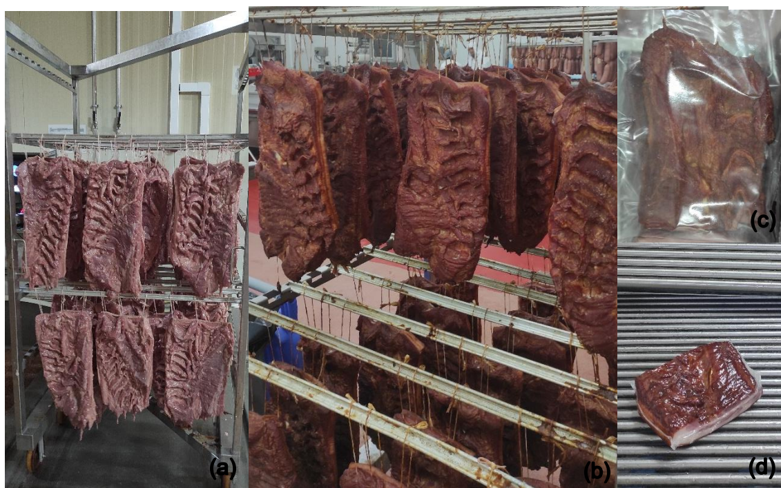
Figura 9. Processo produtivo do bacon extra: peças são suspensas antes do tratamento térmico inicial (a), câmara de estabilização (b), embalagem primário (c), e túnel de retração (d).
