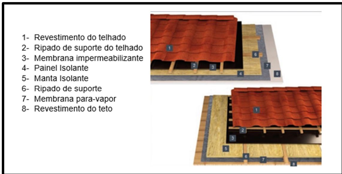
Figura 2 -Exemplo Imperialum - Cobertura Inclinada (Isolante nas vertentes)
