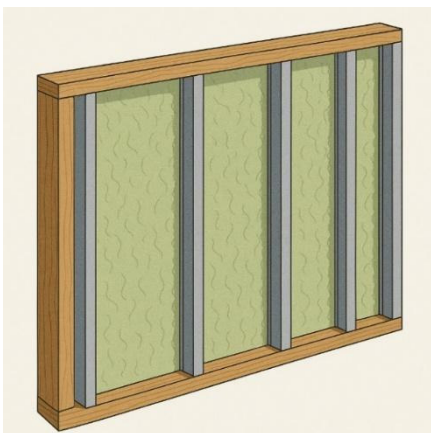
Figura 40 - Esquema técnico gerado por inteligência artificial: parede de madeira com montantes metálicos e isolamento em lã mineral.
