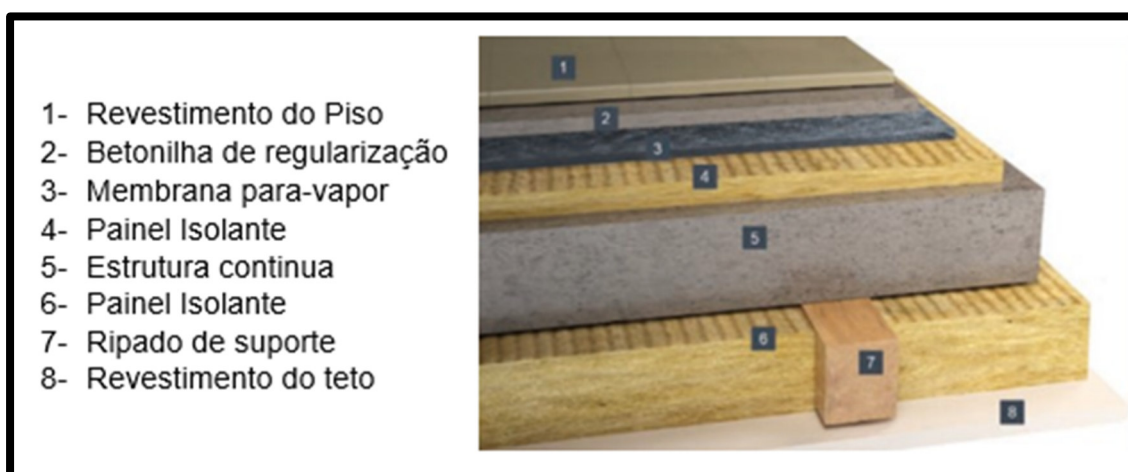
Figura 11- Exemplo Imperialum - Pavimento sobre espaço exterior
