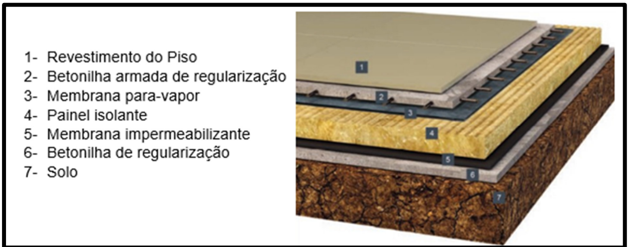
Figura 12 - Exemplo Imperialum - Pavimento subterrâneo
