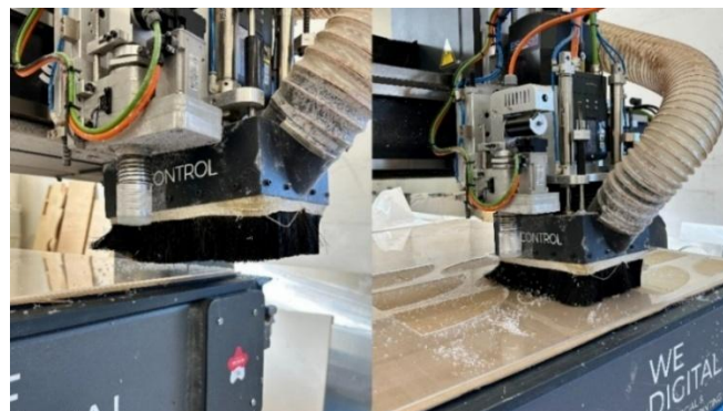
Figura 29: CNC utilizada para o corte das peças dos prémios em acrílico.
