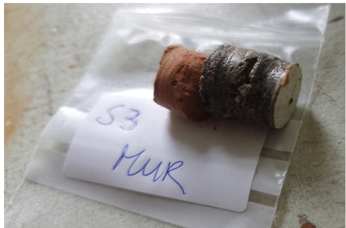
Figura 4 - Amostragem realizada com broca diamantada do tipo serra-copo (inpto Engineering)
