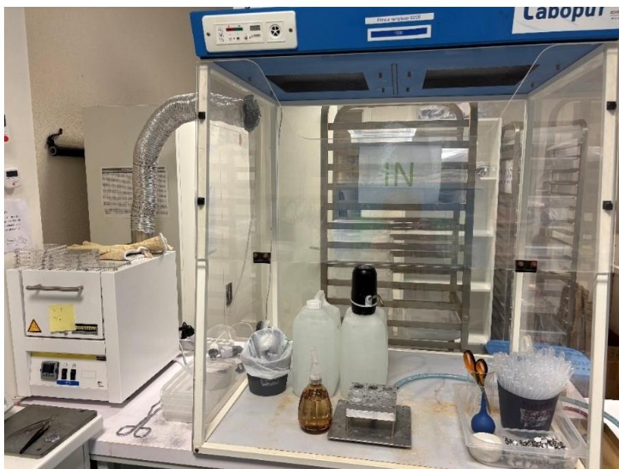
Figura 5 - Hotte de preparação com forno de calcinação para análise de diferentes resíduos (Laboratório Toxias, Satigny CH)
