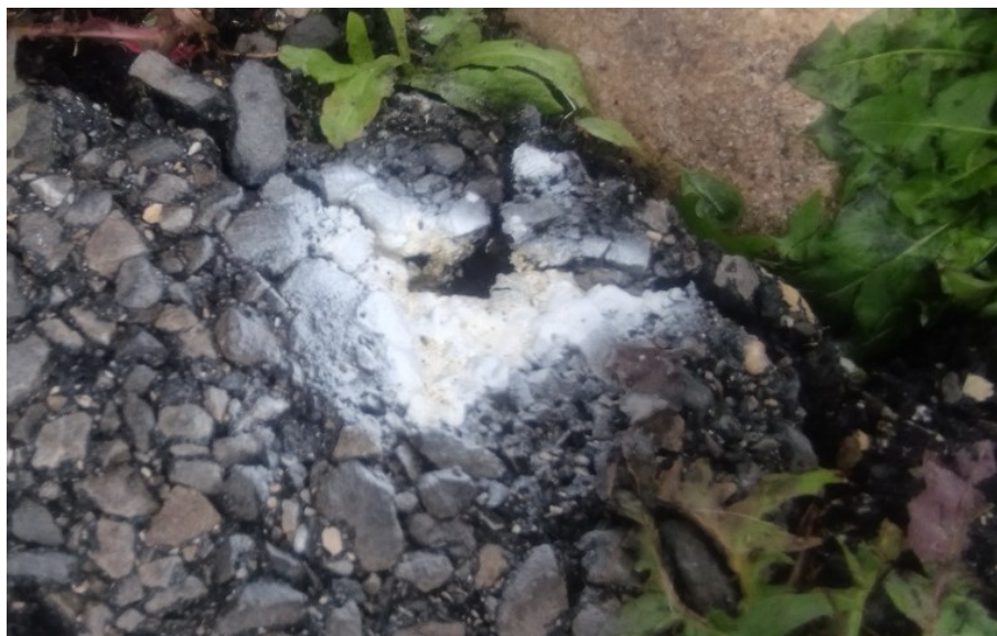
Figura 8 - Amostra HAP testada positiva com Pak-Marker® (Inpto Engineering)
