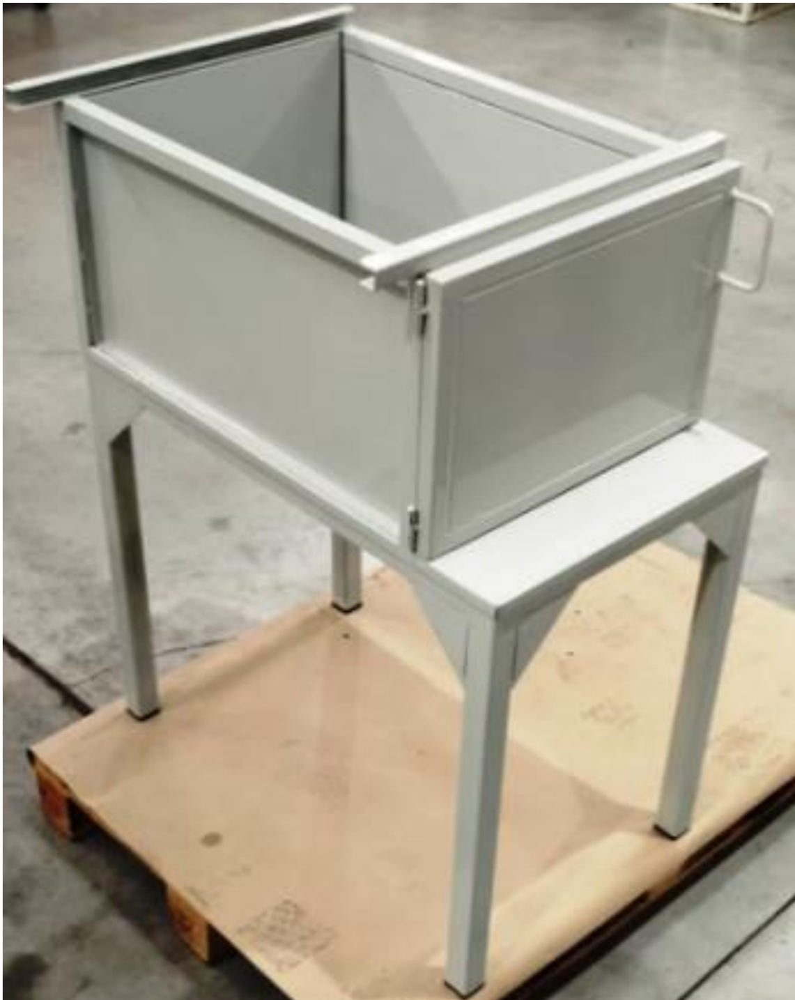
Figura 14 - Estrutura metálica da jaula de qualidade
