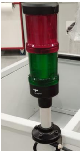
Figura 21 - Semáforo de sinalização
