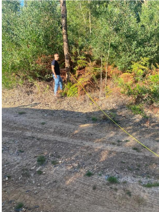
Figura 3.2. Medição da distância entre o hipsómetro e o alvo para calibração.
