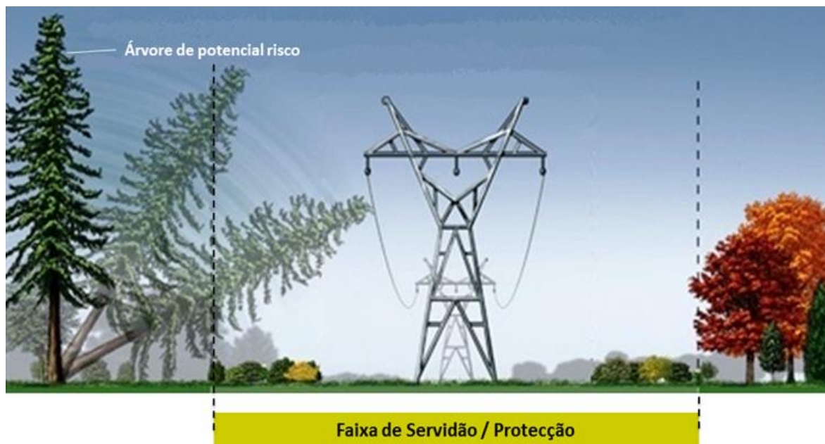
Figura 1.2 - Representação de situações de risco de árvores fora da faixa de servidão/proteção. Fonte: REN (2025).
