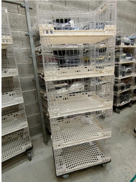
Figura 5- Exemplo de "torre" móvel utilizada para armazenamento e transporte de mercadoria
